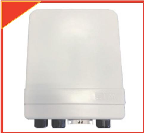
ROE da 32 U.I. (NMU 771784), in grado di alloggiare fino a 4 splitter secondari, costituito da un involucro ed un modulo interno, con posa a sbalzo, utilizzabile solo come ROE terminale.
