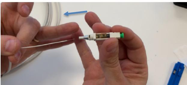
Il connettore può essere riaperto per riprovare l'installazione per valori di attenuazione non conformi fino a 5 volte.
