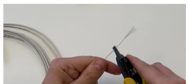
4. Con il foro intermedio della stripper rimuovere la guaina da 900 µm per un minimo di 20mm.
