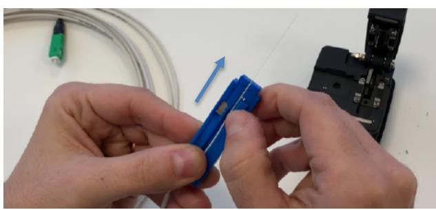
12. Muovere la leva del supporto per bloccare la guaina da 900 µm all'interno del supporto stesso.
