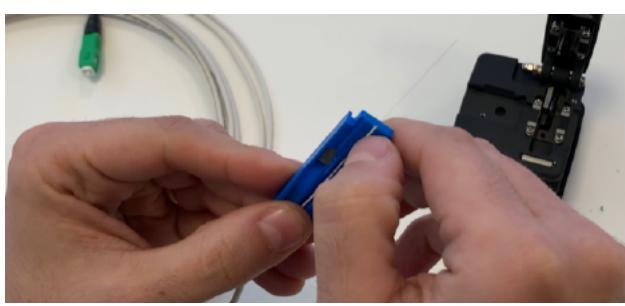
11. Inserire la fibra all'interno del supporto facendo combaciare la fine della guaina 900 µm con la fine del supporto.
