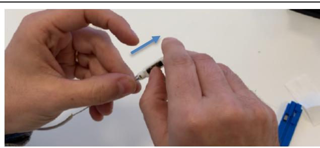
18. Tenere con una mano la posizione ottenuta con la fibra a battuta e con l'altra spingere verso la parte anteriore del connettore la leva gialla fino a fine corsa.
