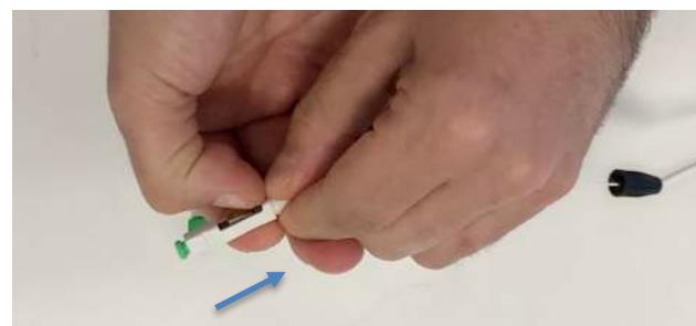
3. Tenere con una mano la fibra e la base del corpo del connettore, e con l'altra mano spingere la leva gialla portandola a fine corsa verso la parte posteriore del connettore.
