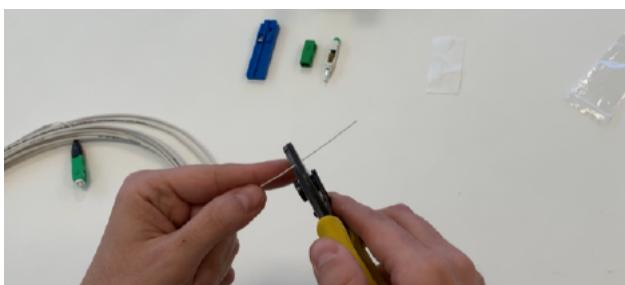
9. Eliminare completamente il rivestimento da 250 µm a vista utilizzando il foro più piccolo della stripper.
