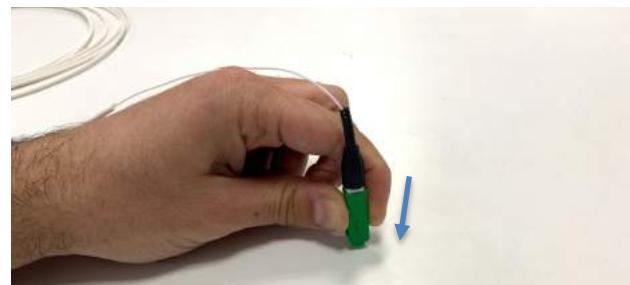
1. Spingere il rivestimento del connettore con la parte anteriore verso una superficie piana, facendo ben attenzione a tenere il tappo sulla ferula del connettore stesso.
