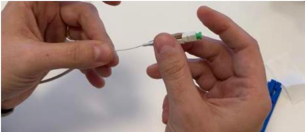
19. Fare una prova di tiro con attenzione applicando una forza minima per verificare se il fissaggio della fibra all'interno del corpo connettore è avvenuto correttamente.
