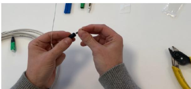
7. Inserire il codino nel boot fino al bloccaggio meccanico dello stesso.
