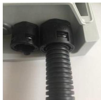
Inserire il cavetto di testa attraverso il foro per una lunghezza di 1 m. Una volta all'interno, sguainare il cavetto 1 cm circa dopo il pettine di fissaggio, eliminando eventuali filati di rinforzo (Kevlar) e fissarlo come mostrato in figura.
