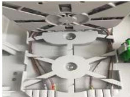
Inserire le fibre all'interno dei moduli di giunzione utilizzando il passaggio dietro ai moduli stessi
