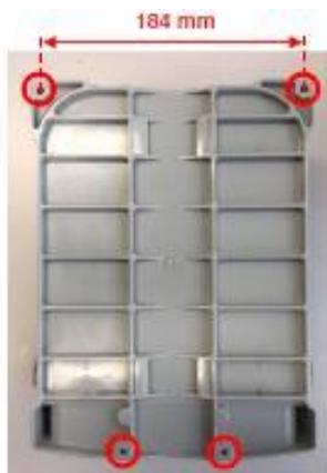
Forare la parete con punta da 6 mm e con interasse orizzontale dei fori superiori pari a 184 mm e fissare il PTE in posizione utilizzando le viti in dotazione (senza serrarle).
