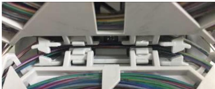
Parcheggiare 24 fibre per modulo nei moduli di giunzione partendo dal modulo in basso.
