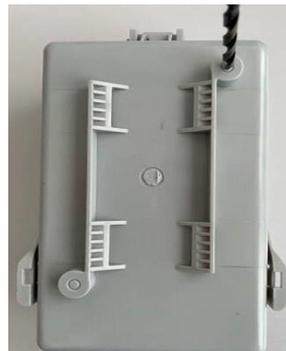
Forare la parete con punta da 6 mm e con interasse orizzontale dei fori superiori pari a 110 mm. verticale e 64 mm. orizzontale ed inserire i tasselli in dotazione nel kit.
