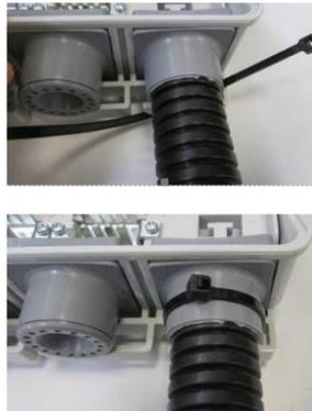
Nel caso di inserimento diretto del cavo, incidere il cono interno della guarnizione n.1 sulla destra del modulo (ingresso dedicato al cavo di rete) con delle forbici.
